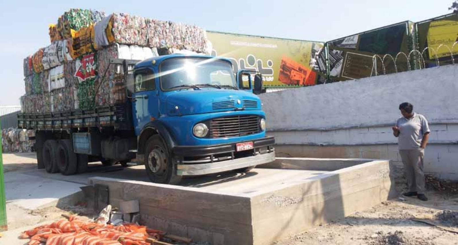
Figura 12.18 - Balança em funcionamento
