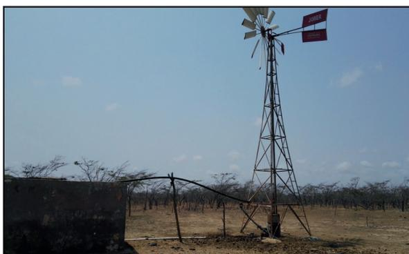
**Figura 4:** Pozo semi-artesanal para la extracción de agua, movido por energía eólica.
