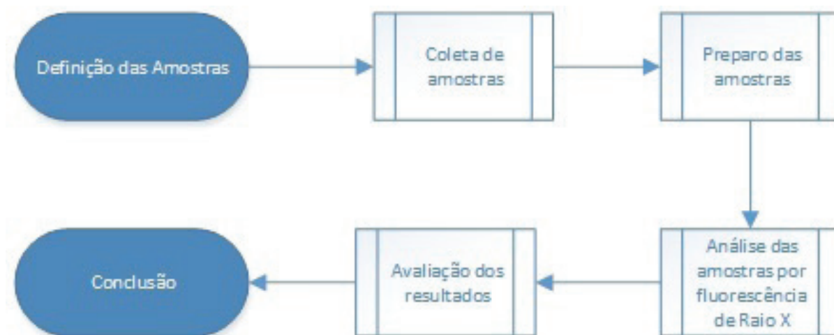
Figura 01 – Etapas do experimento realizado com resíduo sólido proveniente do tratamento de efluentes em lavanderias industriais.
