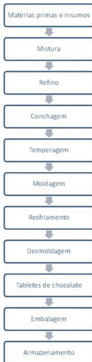
Figura 2. Fluxograma básico da produção de chocolate. Fonte: o próprio autor
